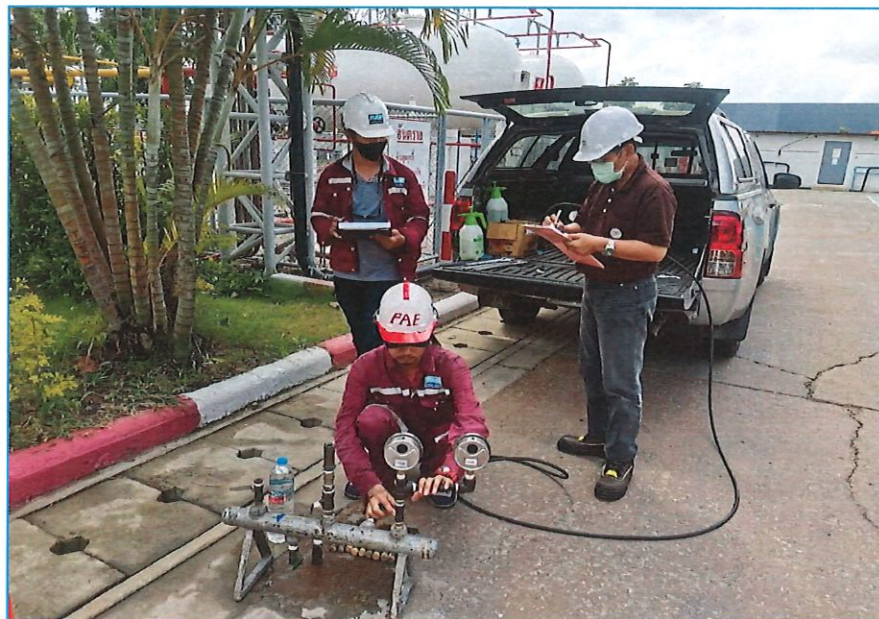
รูปการทดสอบ Safety Relief Valve
